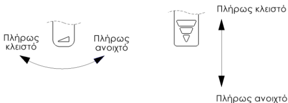
Σχ. 5. Παραδειγματική ρύθμιση της πρόσβασης του αέρα στην εστία
