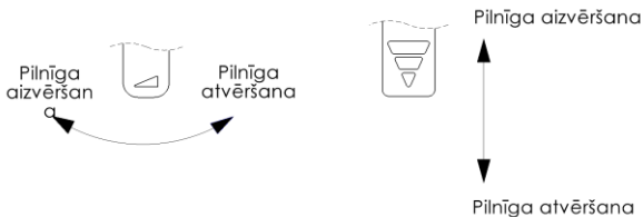
Att. 5 Krāsns gaisa padeves regulēšanas piemērs (skats no krāsns priekšpuses).
