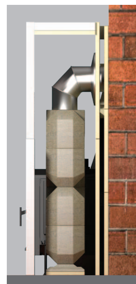
Řez trojvrstvou konstrukcí zadní stěny
