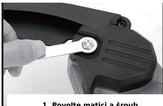
1. Povolte matici a šroub, sejměte kryt a vodící lištu.
