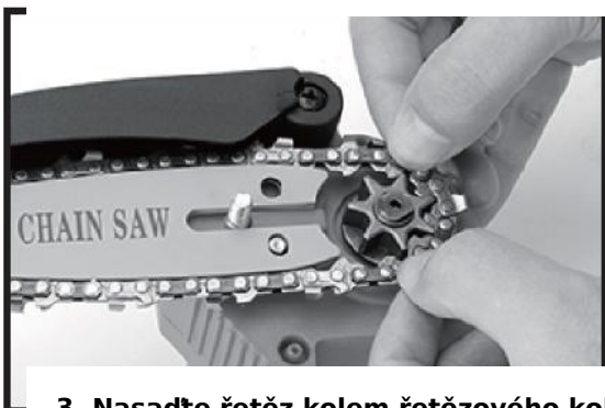
3. Nasadte řetěz kolem řetězového kola a zkontrolujte správné usazení lišty.
